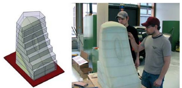
Abb. 7: Positivform der Heckpartie in Catia V5 zur Erzeugung der Fräsdaten und Studenten bei der Bearbeitung des Rohlings im Karosserie-Labor
