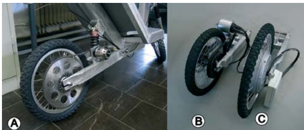
Abb. 5: Austauschbare Antriebsschwingen: DC-Brushless Außenläufer-Motor 3kW und 7-Gang Radnabenschaltung (A), DC-Brushless Innenläufer-Motor 3kW mit 2-stufigen Getriebe, Übersetzungsverhältnis 20:1 (B), Brushless Radnabenmotor 1,8kW „direct drive“ (ohne Getriebe) (C)
